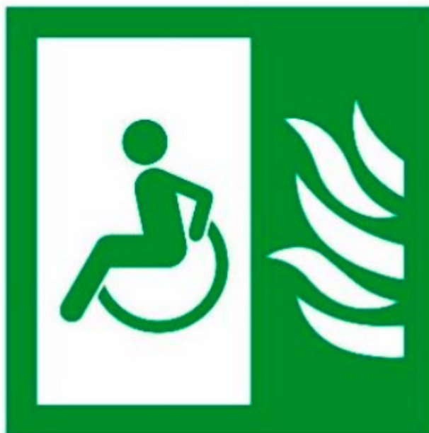
Рисунок 19 — Знак «Безопасная зона для инвалидов» (пожаробезопасная зона)
